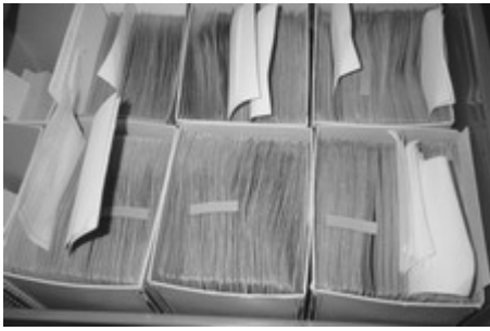
図2 箱の中のフィルムをテストする場合、ストリップを箱の中に入れ、箱を閉じる
