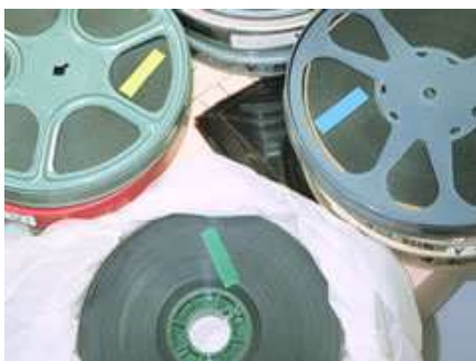
図 1 缶の中のフィルムをテストする場合、ストリップをフィルムの上に置き、缶を閉じる
