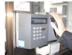
入退室制限 静脈認証等でログ管理
